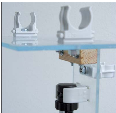
Detailaufnahme der waagerechten Antennenaufnahme und der oberen Clipbefestigung
