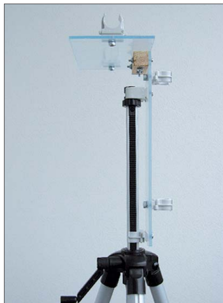
Befestigung der Antennenhalterung am Fotostativ
