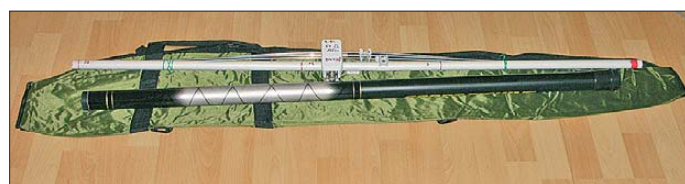
Bild 13: Der Transport der Leichtbau-Yagi ist samt PVC-Boom und Angelrute als Mast leicht in einer Angeltasche möglich.
