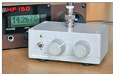
Das robuste Steuergerät der Innenantenne 700DTA nimmt über eine BNC-Buchse an der Oberseite das Empfangselement auf.
