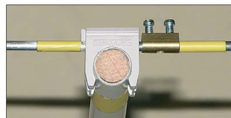
Bild 4: Detailaufnahme des geteilten Reflektorelementes; das Boomrohr wurde mit einem runden Holzstück verstärkt.
