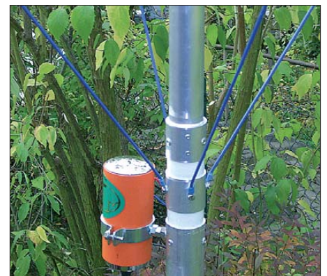
Bild 3: Hier ist der Anpassübertrager mit dem modifizierten Isolator und den Anschlüssen der Seitenstrahler zu erkennen.
