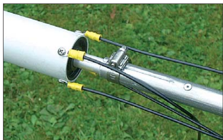
Bild 4: Befestigung der Seitenstrahler an der Ladespule
