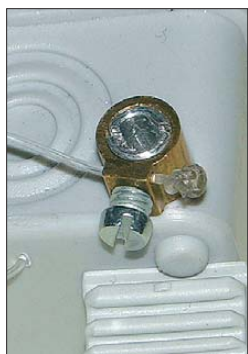
Bild 6: Strahlerhalterung von DH6RM für die 4 mm dicken Elemente
