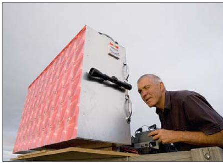
Ein Fernrohr diente zur korrekten Ausrichtung des Senders.
