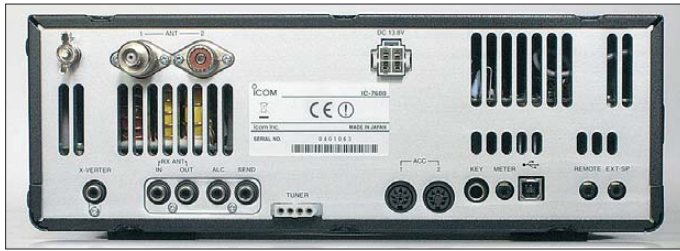
Bild 2: Die übersichtliche Rückfront des IC-7600; auf die zweite PL-Antennenbuchse ist hier ein Adapter geschraubt. Der leise Lüfter befindet sich hinter der Frontplatte, s. Bild 3.
